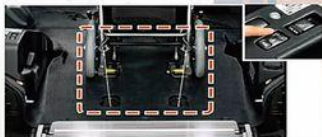
電動式地台輪椅鎖 Electronic Wheelchair(s) Lock
