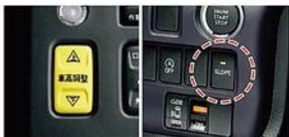
可調較式全電動尾懸掛系統 Electronic Adjustable Rear Suspension
